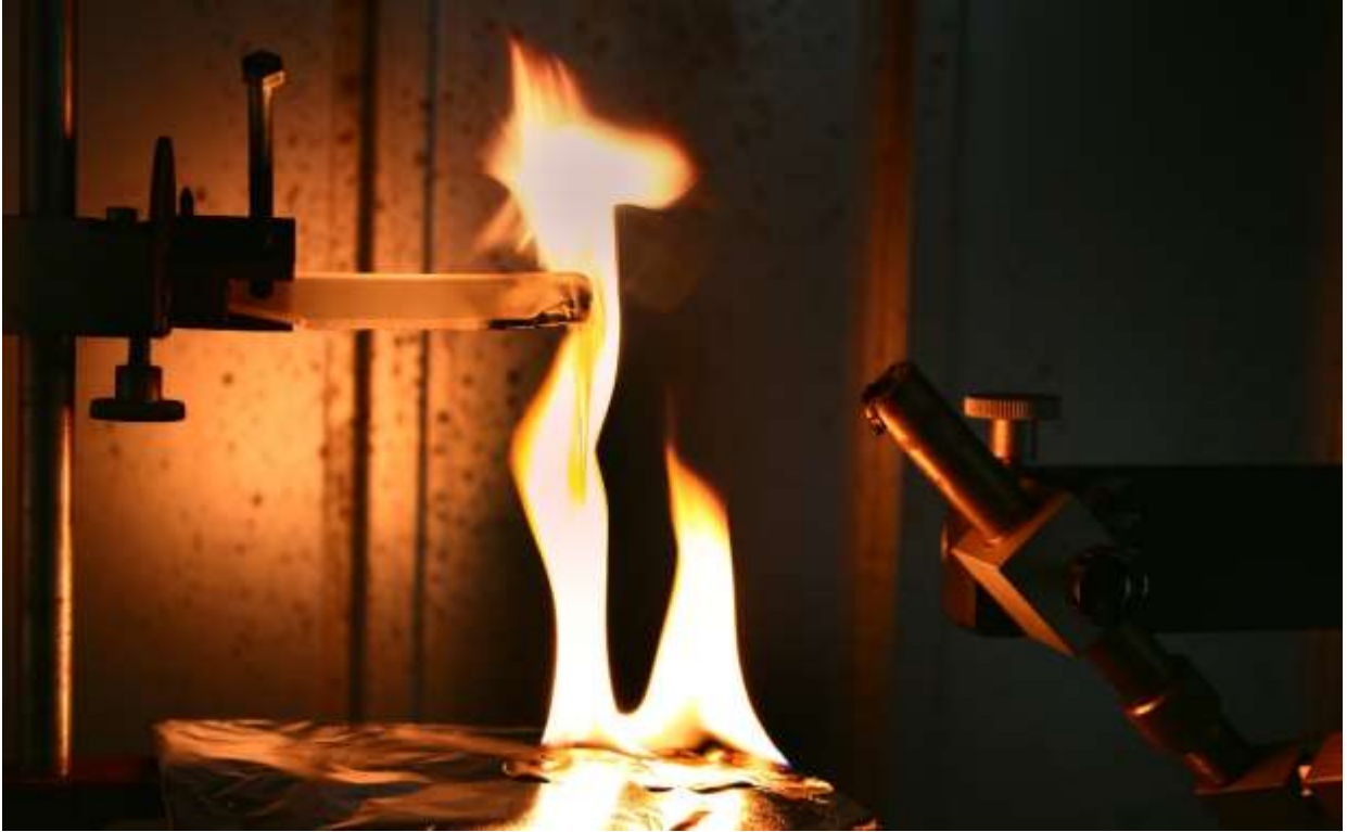
Infiammabilimetro presso il Centro Ricerche ENEA di Brindisi
